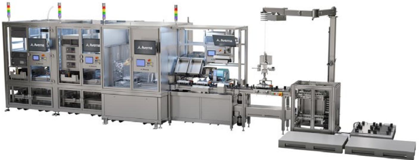
Die **Testexpertise** von Averna lässt Sie die Markteinführung Ihrer **EV-Power-Komponenten** zuverlässig beschleunigen. Die anpassbare und vollständig skalierbare EV-Testplattform automatisiert **Sicherheits-, Funktions- und Dichtigkeitstests** mit **Teilekennzeichnung** und **Qualitätsprüfung** für gängige EV-ECU-Module. Sie können nur erforderliche Funktionen wählen oder mehrere Systeme zu einer Komplettlösung verknüpfen.
